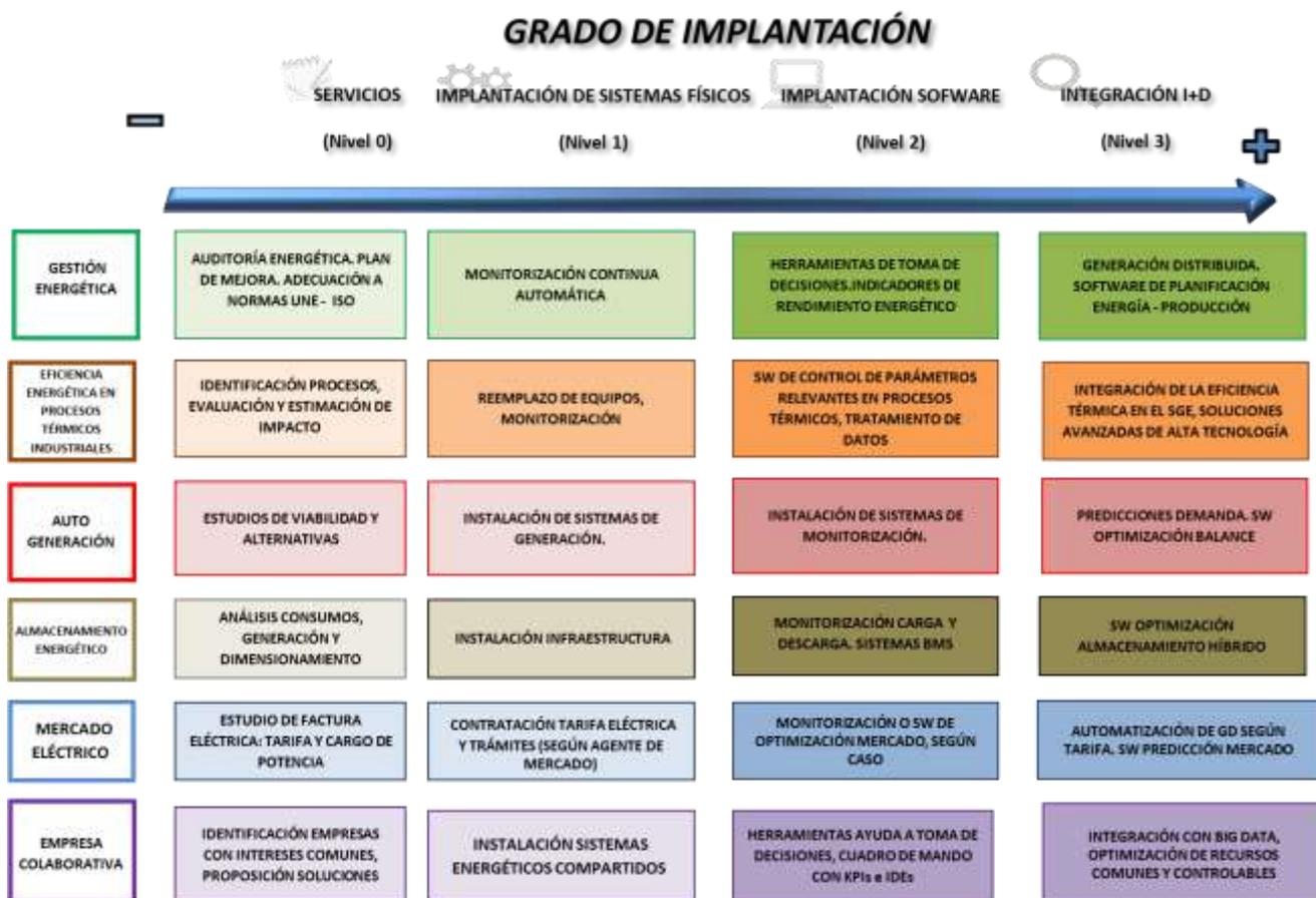
Figura 18. Mapa técnicas eficiencia según su grado de implantación digital. ITE
