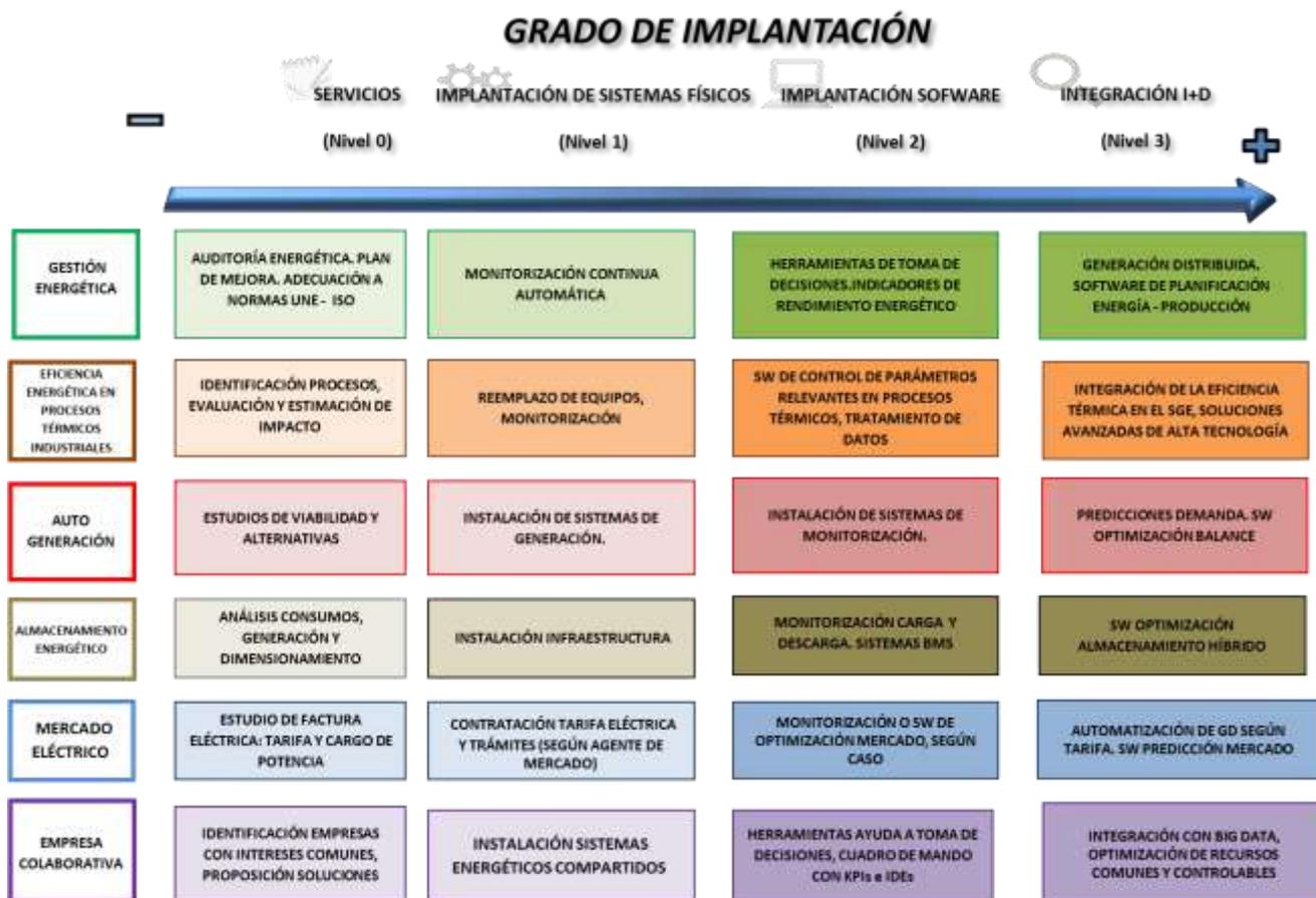
Figura 16. Mapa técnicas eficiencia según su grado de implantación digital. ITE
